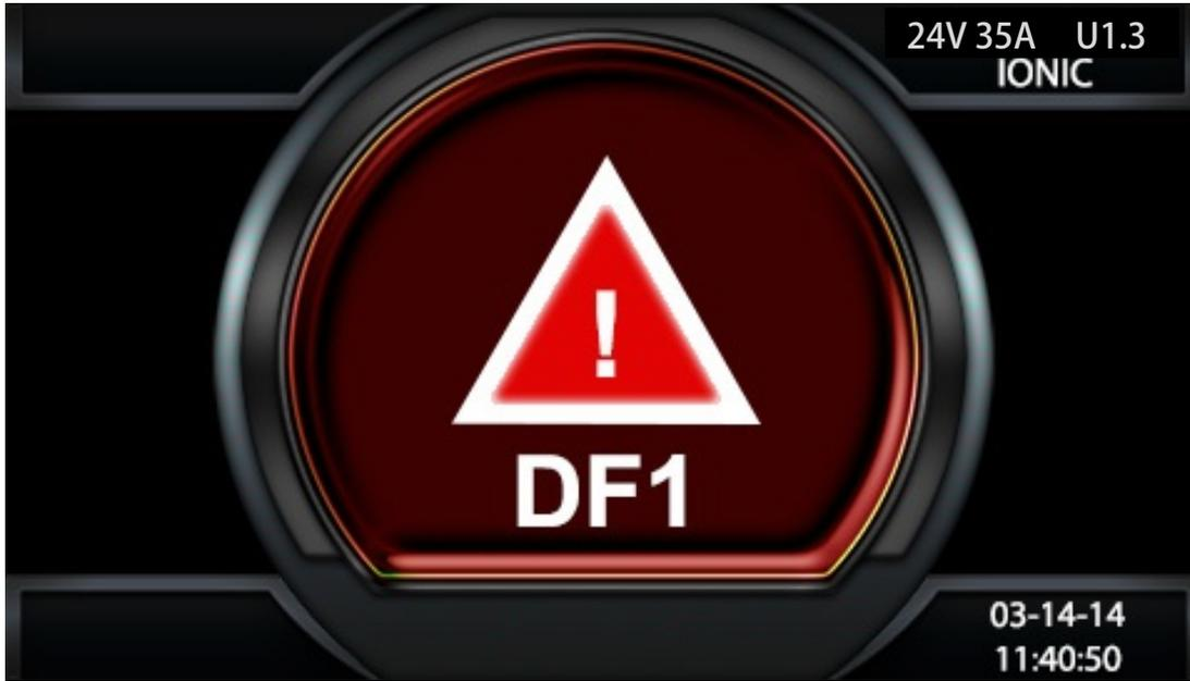
En caso de una falla, aparecerá en la pantalla uno de los códigos de falla correspondiente indicado abajo. Si es una falla crítica, la carga se detendrá y el LED rojo de falla se iluminará.
