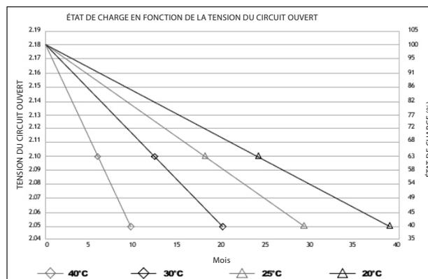
recommandé d'inspecter visuellement la batterie et de vérifier la tension en circuit ouvert après 12 mois, puis de recharger la batterie si la tension en circuit ouvert est inférieure à 2,10 volts par élément. Si la température du lieu d'entreposage dépasse 30 °C (86 °F), la batterie doit être vérifiée aux six mois. Le graphique ci-dessus illustre la relation entre la température, la durée d'entreposage et la tension en circuit ouvert.
